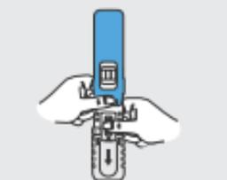
5. Tenere la cassetta test in senso verticale con la fiala in basso. **Collocare in orizzontale il proprio pollice al centro della parola PRESS e premere forte in una sola volta fino a rompere la fiala.** Continuare a **tenere la cassetta per altri 10 secondi come mostrato in figura.**
